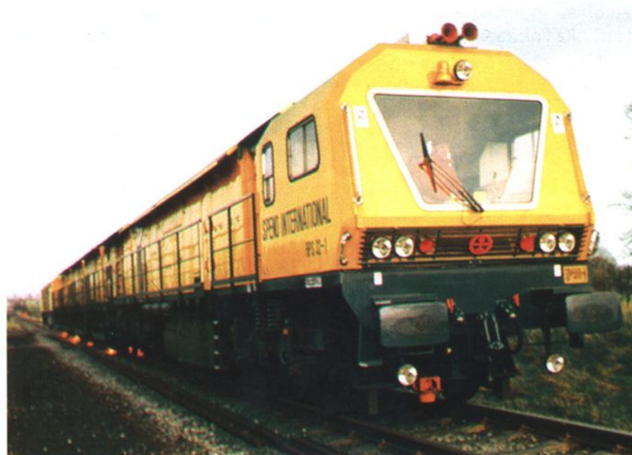
Fig. 4 - Le train à grand rendement Speno RPS 32 a été utilisé dans le cadre du projet pilote pour le meulage de la pleine voie
