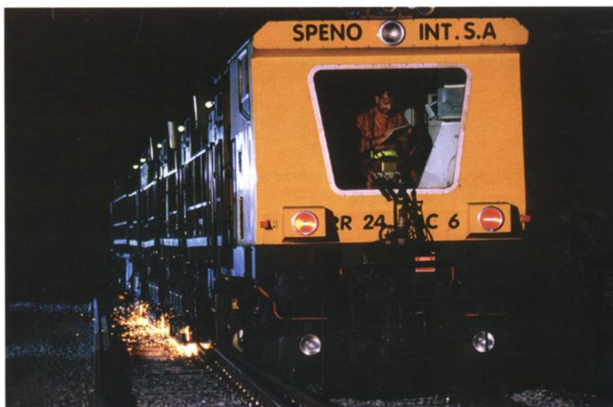
Fig. 3 - Le train polyvalent Speno RR 24 MC a été utilisé pour un projet pilote ayant pour but de développer une nouvelle méthode de travail dans des conditions difficiles (ponts, appareils de voies, passages à niveau)
