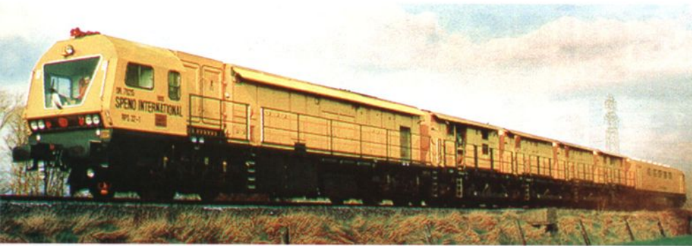
Fig. 1 - Le train à grand rendement Speno RPS 32 travaillant sur le réseau néerlandais
